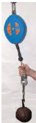
FOTO 6: Blocfor™ con peso da 10 kg e fune tenuta bloccata dall'operatore che sta eseguendo il controllo.
